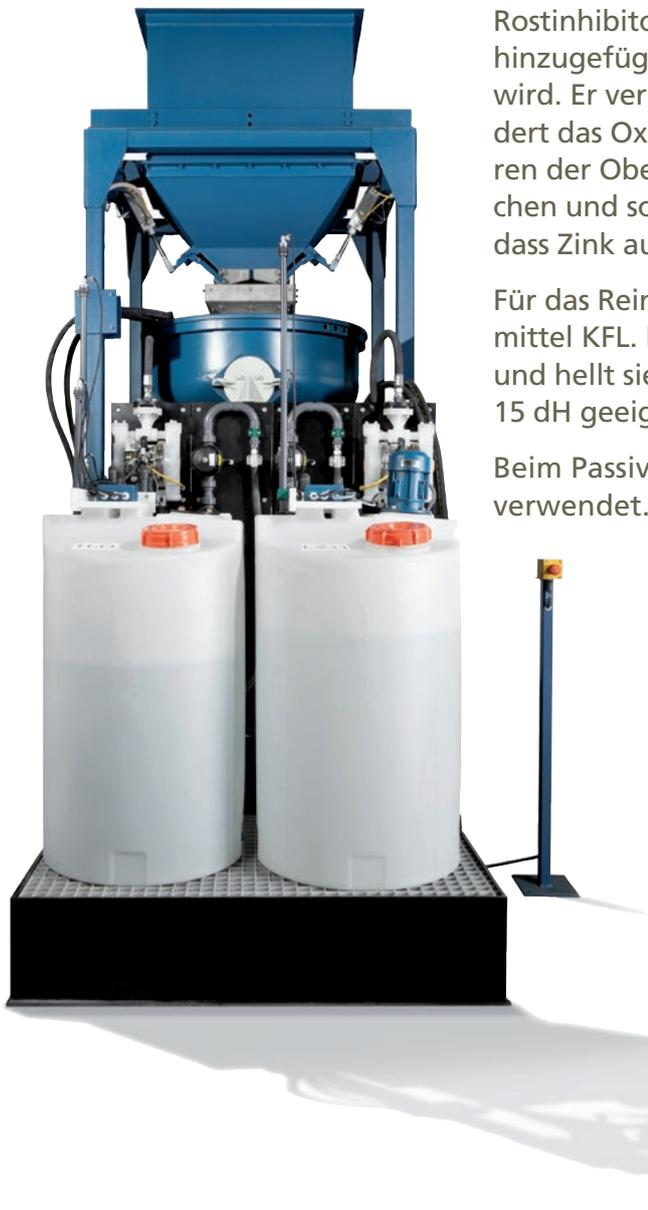
Die einzelnen Compounds werden dem jeweiligen Prozessschritt entsprechend automatisch dosiert und in den Arbeitsbehälter gefördert.
