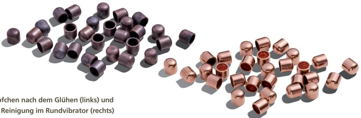
Näpfchen nach dem Glühen (links) und der Reinigung im Rundvibrator (rechts)
