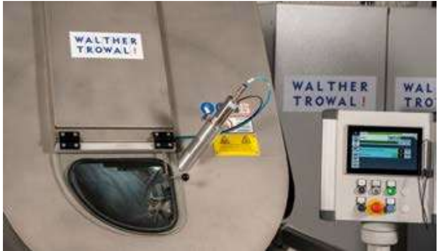
Der 2022 in Betrieb genommene Rotamat R 90C verfügt über eine intuitive Touchscreen-Benutzerführung, mit den neuen Steuerungen kann ein Bediener drei Maschinen gleichzeitig fahren.
