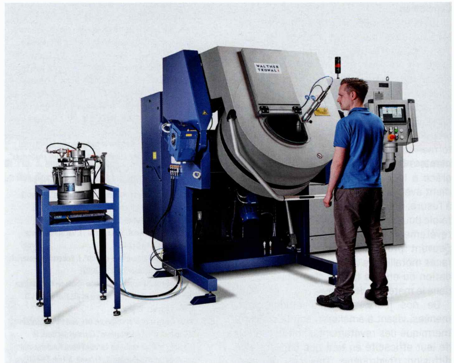
■ Abb. 1. Der neue Rotamat R 100 eignet sich für das Beschichten von Kunststoffteilen bis zu 300 mm Durchmesser.
