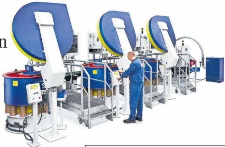
Oben: Eine Fertigungslinie mit CB-300-Rundvibratoren. Unten: Eine Turbotron(TT)-Anlage als Zwei-Chargen System. In der Siebzone am Auslauf eines Rundvibrators werden die Werkstücke von den Schleifkörpern getrennt
