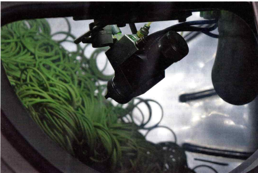
Die neuen PFAS-freien Gleitlacke sind auf den Einsatz in der Trommel-Beschichtungsmaschine abgestimmt.
